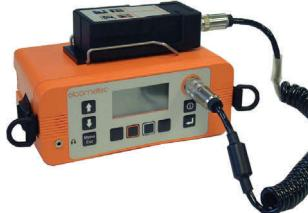
Grundet deres store modstandsevne mod korrosion forårsaget af klorider er det i de senere år blevet mere og mere almindeligt at bruge armeringsjern af rustfrit stål. Eftersom rustfrit stål stort set er umagnetisk, har det indtil nu ikke været muligt for traditionelle covermetre at lokalisere dem præcist.
