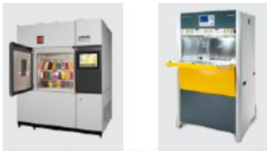
Figur 12: Ci5000 Weather-Ometer® (roterende prøvestativ) og SUNTEST XXL+ (flatbed) i Atlas' laboratorium til accelereret vejrpåvirkning i Mount Prospect, Illinois, USA.
