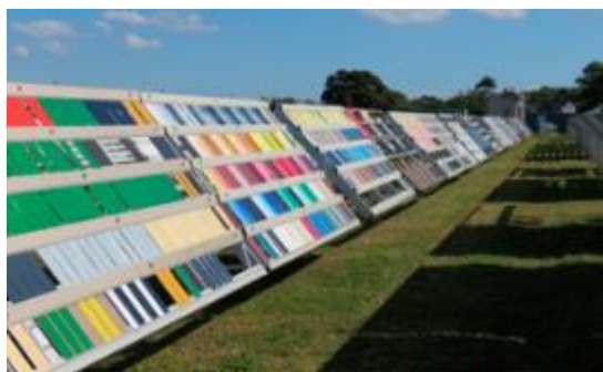
Figur 3: Prøveemner placeret på stativer til udendørs eksponering på Atlas' testområde i det sydlige Florida.
