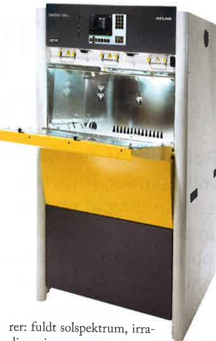
rer: fuldt solspektrum, irradiansniveau, temperatur og fugt. Xenon-instrumenters optiske filtre giver fuldspektrede solstrålingsforhold i UV-, VIS- og IR-området 295-2500 nm.
