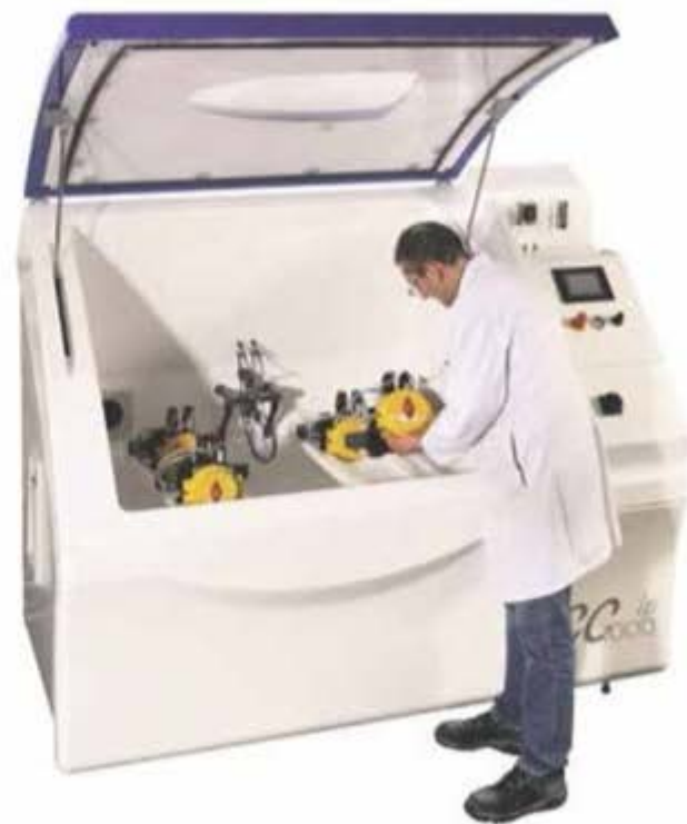
CC450IP-salttågekammer fra Ascott i brug til test af elektronik udsat for forhold, der svarer til virkeligheden over en længere brugsperiode.
