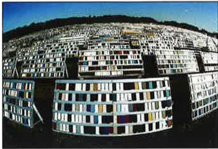
Sydflorida anvendes ofte til ægthedstest grundet det varme og tørre klima. Her ses en teststation med opsatte plader i netop Sydflorida.
