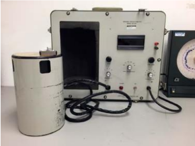
Figur 2: Gier-Dunkle DB-100 bruges til at måle varmeudstråling.
