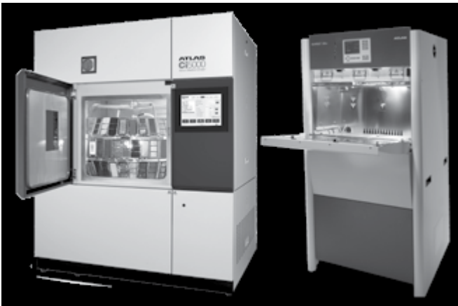
Figur 6: Xenonapparaterne Weather-Ometer® model Ci5000 med roterende prøveholder og SUNTEST® XXL+ flatbed.
