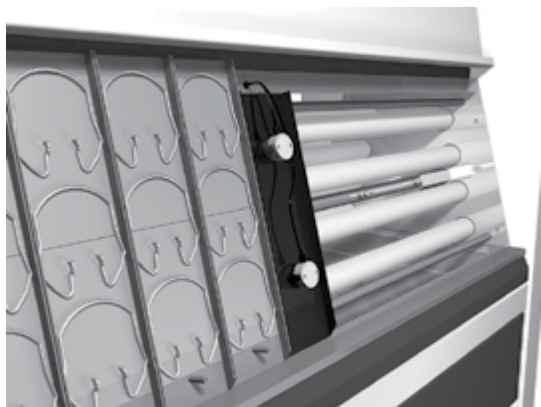
Figur 7: Inde i en Atlas UVTest ses UV-lamper, Black Panel temperaturkontrol og ergonomisk designede klemmer til fastholdelse af prøveemner.
