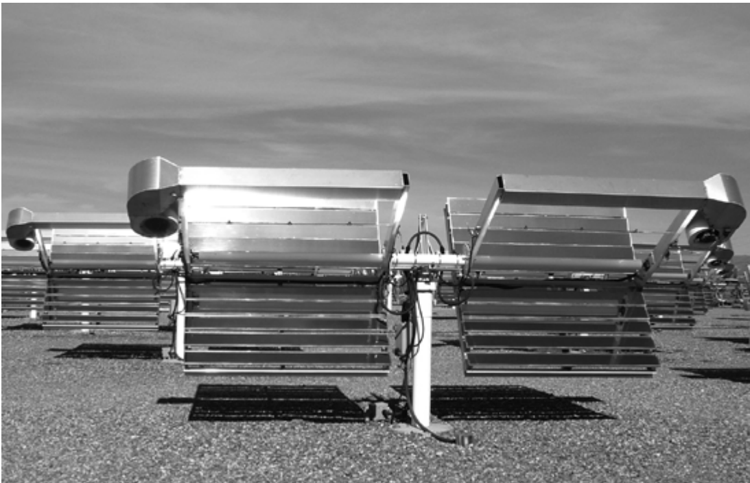
Figur 4: EMMAQUA® solkoncentrator til accelererede vejrtest.
