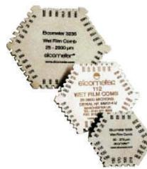
Elcometer model 112/1 er en holdbar og præcis vådfilmeskam i rustfrit stål, der anvendes til at bestemme tykkelsen på våd maling, før den hærder. Den er sekskantet og har således flere forskellige tykkelsesværdier og dermed større aflæsningsnøjagtighed. Den kan måle op til en maksimaltykkelse på 3.000 µm, og denne høje øvre værdi gør det muligt at måle tykke belægninger, der kan være vanskelige at teste efter andre metoder.
