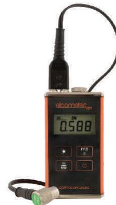
NDT-apparaterne har alle et ergonomisk udformet forseglet metalhus samt vand- og støvtæt folietastatur. De anvendes sammen med en af de mange transducere der kan måle materialer ved temperaturer op til 482° C. Afhængigt af modellen har apparatet forskellige funktioner såsom gentageligheds-/stabilitetsindikator, differentialfunktion, alarm for minimumstykkelse, grænsealarm og V-sti-korrektion.
