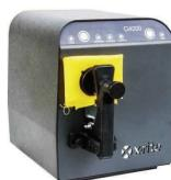
**Ci4200** mäter farver på blanke og matte overflader med eller uden overfladestruktur.
