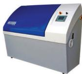
Som ekstraudstyr til model 618 fås en kompakt luftkonditioneringsenhed, der gør det muligt at køre testcyklusser ved lave temperaturer ned
