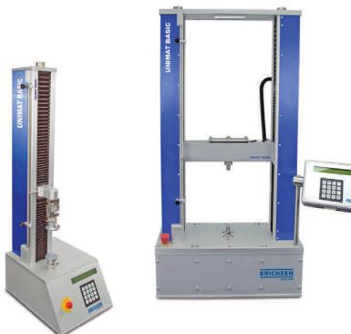
UNIMAT®-maskinerne kan styres via USB, men leveres også med et Windows-program til styring, registrering, visning og lagring af data. Kræfter og afstande vises, sammenlignes og lagres. Softwaren kører under Windows 95/98/2000 / XP og NT / W7 eller W8.
