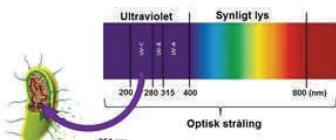
UV-C-desinfektion er en ekstremt virkningsfuld fysisk metode til bekæmpelse af alle former for mikroorganismer. Kortbølget UV-C-stråling bekæmper effektivt bakterier, gærsvampe, svampesporer o. lign. ved at
