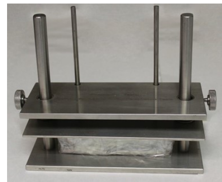
De indpakkede plader med stofprøver og kontrolstoffer placeres herefter i Perspiration Tester M231.
