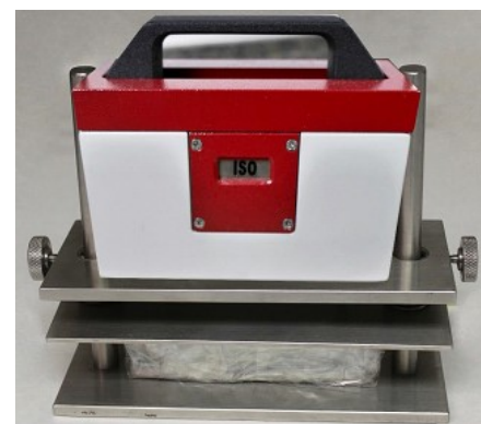
Den passende vægt placeres nu oven på testinstrumentet for at påføre de indpakkede prøver et konstant tryk. Pladerne fastgøres derefter ved at dreje på knapperne på siden af instrumentet. Herefter fjernes vægtene og instrumentet placeres i laboratorieovnen (G209A/B) i 16 timer.
