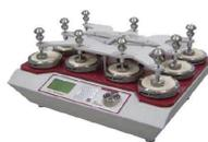
**Martindale Abrasion Tester** (ISO 12945-2 tekstiler) er meget brugt til pilling test. Testen foregår ved, at et rundt prøveemne,
