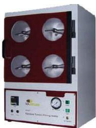
**Random Tumble Pilling Tester** (ASTM standardtest D3512) simulerer pilling og fuzzing, der opstår i forskellige slutbrugs-situationer, ved at prøverne tromles i et cylindrisk prøvekammer beklædt med et let slidende materiale, samtidig med at der
