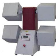
**ICI Pilling Tester** (ISO 12945-1) bruger også en korkindsats som slidende overflade; men denne er placeret inde i en stor firkantet boks, og korken skal ikke udskiftes, medmindre den beskadiges
