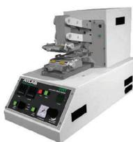
**Stoll Quartermaster Universal Wear Tester** (ASTM D3514) er en unik pillingstest, der simulerer effekten af stof der gnider mod huden, ved at stofprøverne gentagne gange gnides mod en elastisk pude af silikonegummi.
