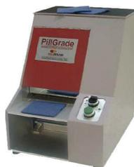
**PillGrade™** er et 3D-scannings-system til objektiv og gentagen test af stofprøvers overfladeegenskaber, hvor softwaren behandler det indfangede billede samt tæller og måler graden af pilling og fuzzing. Resultaterne fås enten i ASTM eller ISO klassificering.
