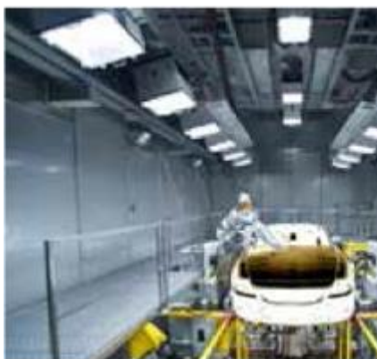
Klimakammer med dynamisk vej- og solsimulator.
