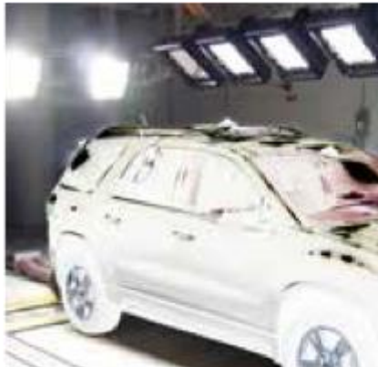
Klimakammer med dynamometer og solsimulator.
